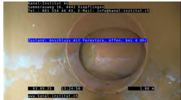
2, 00:03:04, 1.80m Anschluss mit Formstück, offen, bei 4 Uhr
